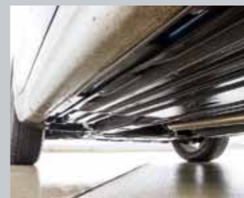
Spodek vozu je přesto bez výstupků, filtr pevných částic je ukrytý u motoru
