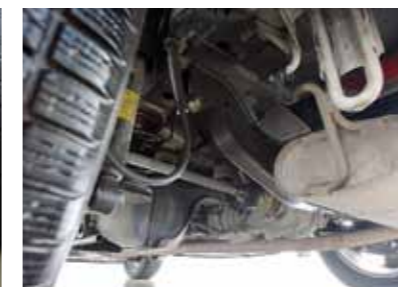
Vedení výfuku ukazuje, že do těžkého terénu mokka nemíří
