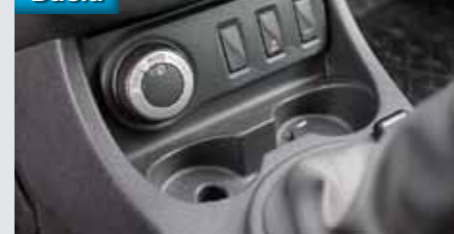
Elektromagnetické ústrojí pohonu 4x4 má pro kluzké povrchy režim Lock s přísnější logikou připojování
