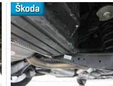
I yeti má výfuk vedený spodem, mezi profily ramen ale tolik nevyčnívá
