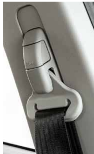
Výškově nastavitelné přední pásy najdeme ve všech testovaných vozech včetně dusteru
